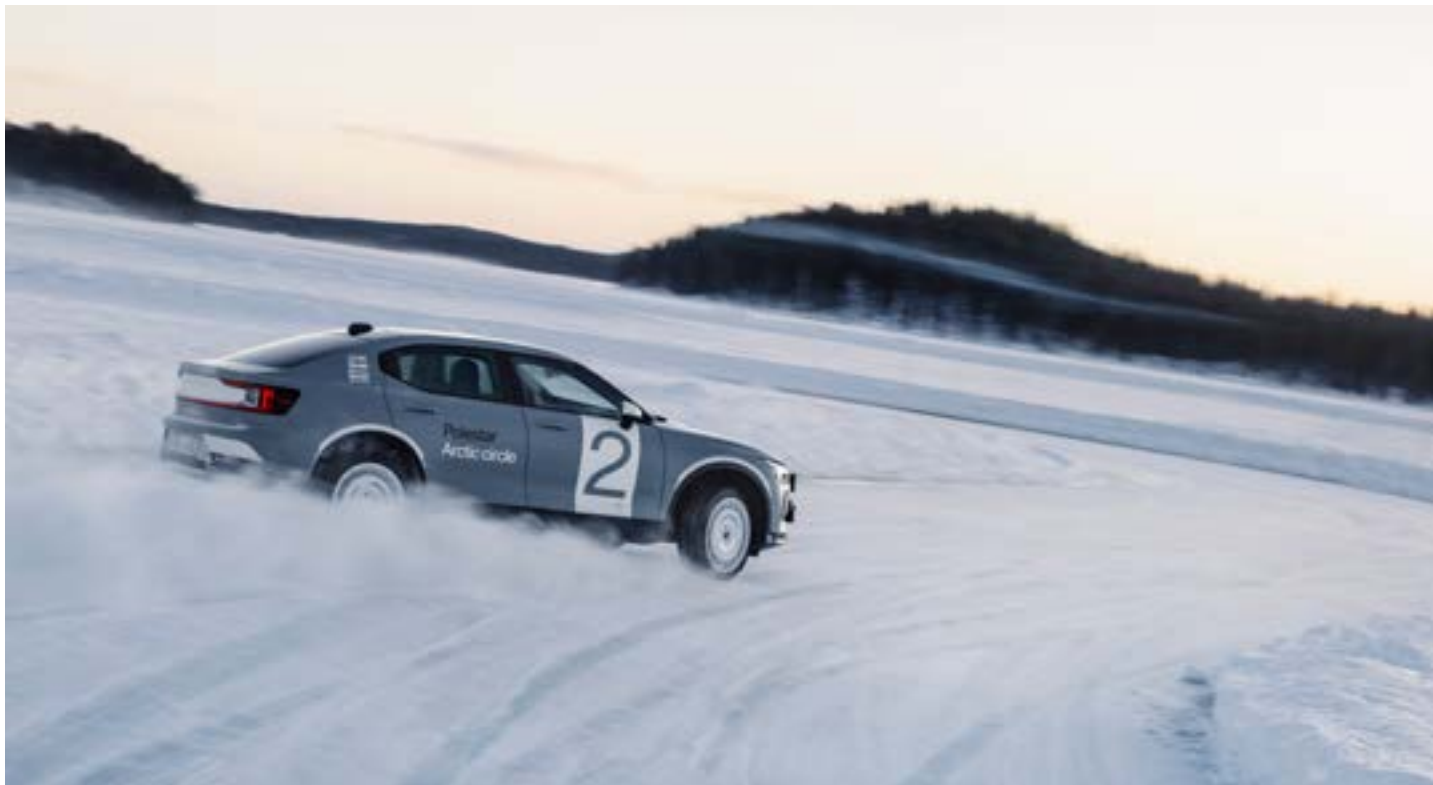
Denne unike rallyinspirerte utgaven av Polestar 2 er basert på en Long range Dual motor med Performance-pakke. Modifiseringene inkluderer økt bakkeklaring (+30 mm), et launch control-system, og spesiallagde dekk med 4mm lange metallpigger som spikrer Polestar 2 Arctic Circle til underlaget ved snø og isete forhold. Både i svingene og på rettstrekket.
